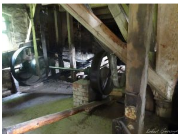
Pod podłogą tartaku kryje się system napędowy traku
